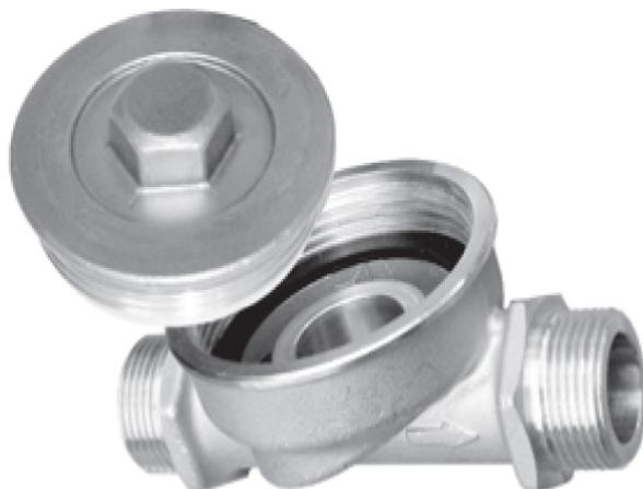
Элемент в разъемном исполнении соединяется с измерительной частью посредством резьбового соединения. Такая конструкция позволяет проводить ремонт теплосчетчика, не демонтируя проточную часть уже установленного прибора.
